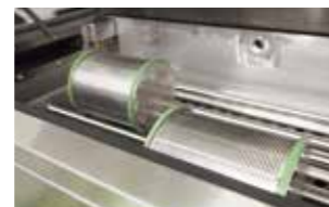
数カ月寝かせた大麦を水に浸して発芽させ、焙燥して1カ月ほど熟成させます。食品開発センターには、ビール会社にあるのと同じ試験製麦装置が配備されています。
