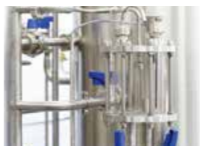
ろ過した麦汁にホップを加えて煮沸し、香りや苦味をつけるとともに殺菌します。次に麦汁から不要物を取り除き、熱交換器を通して冷却します。
