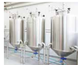
麦汁に酵母を加えて発酵させ、できた未熟なビールを貯蔵タンクで熟成させます。食品開発センターでは100リットルのタンク3つを使って、さまざまなビールを醸造します。
